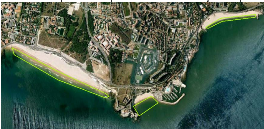
Figura 8 Caixas de monitorização utilizadas para quantificar o impacto da pluma de cada uma das ribeiras para as águas balneares da Carcavelos, Torre e Santo Amaro de Oeiras.
